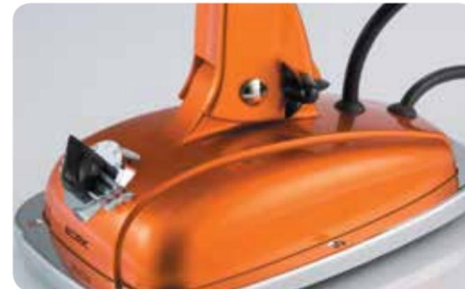
Используйте регулятор на основании корпуса, чтобы поднять или опустить направление воздушного потока.
