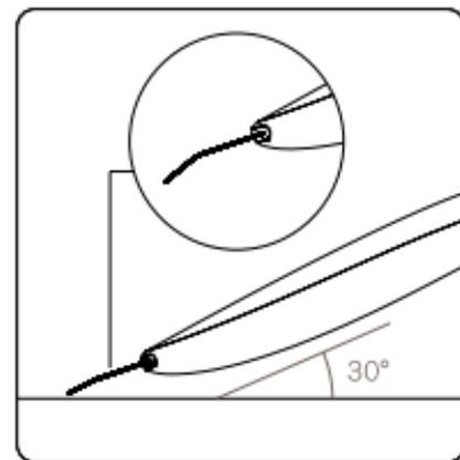
Положение лопатки в режиме очищения
